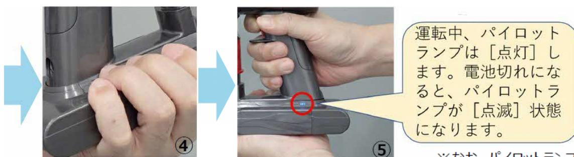
④手のひらをバッテリー一底面指をバッテリー上面にあてがう
